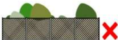
Áttört kerítések nádszövettel való zárása nem megfelelő.
