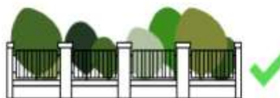
Oszlopos kerítés 1/3-ad lábazat és 2/3-ad áttört részzel.
