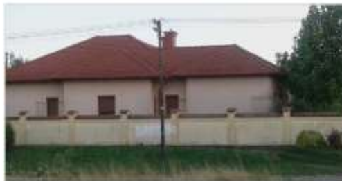
Oszlopos kerítés 1/3-ad lábazat és 2/3-ad áttört részzel.
